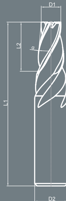
konischer Schaftfräser KSF conical solid carbide endmills
